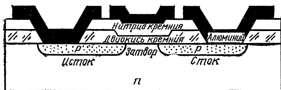
Рис. 2.45. МДП-транзистор с кремниевым затвором
